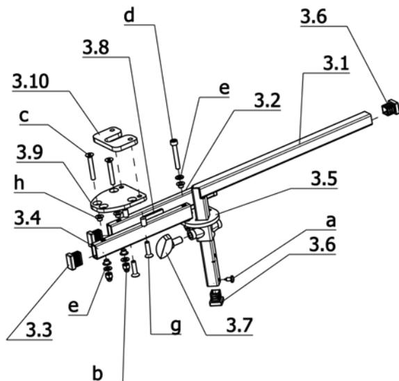
**U-Bg.: Code 4860; Bedienmodulhalter längen-, höhen- und abschwenkbar verstellbar**
