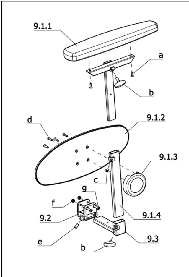
**U-Bg.: Code 106; Seitenteil gepolstert, abnehmbar, groß, höhenverstellbar, gepolsterte Armauflage**
