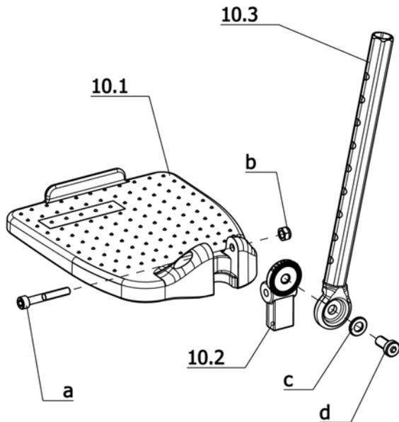
**U-Bg.: Code 128-808; Fußplatten winkelverstellbar; Fußplatten Kunststoff geteilt**
