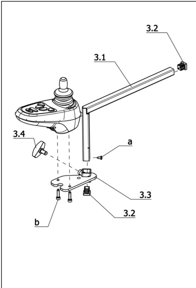
**U-Bg.: Code 4566; Bedienmodulhalter höhen-, längenverstellbar**
